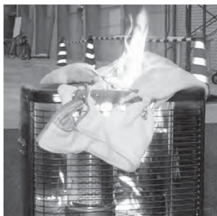
ストーブの上に洗濯物が落下!
